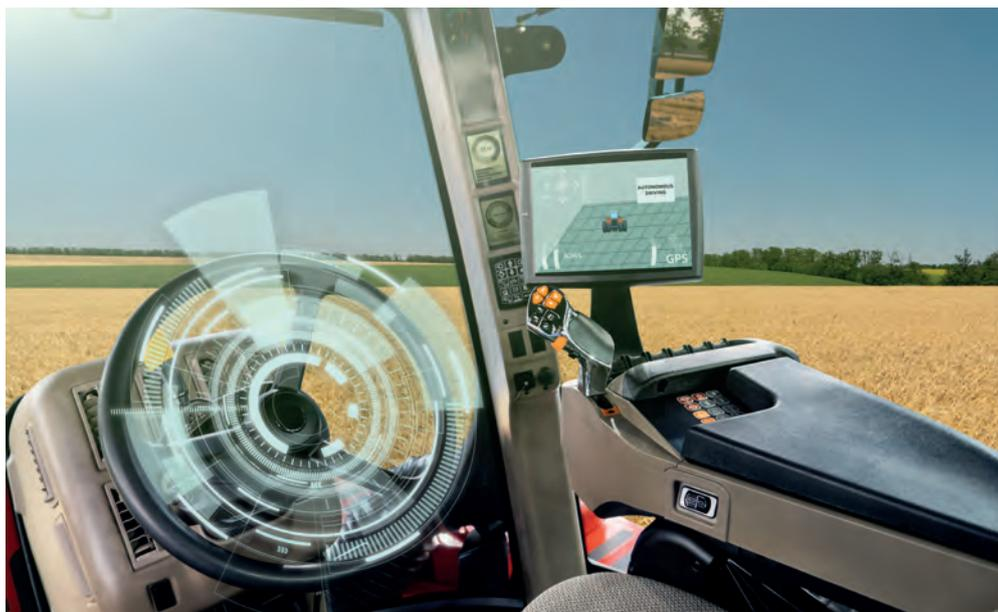
Landmaschinen fahren mit Hilfe von SAPOS® mit einer Lagegenauigkeit von ein bis drei Zentimetern.
