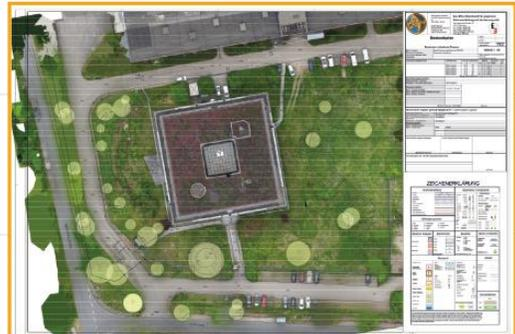
Betrieblicher Auftrag 2024: Digitaler Bestandsplan aus Befliegung mit UAV
