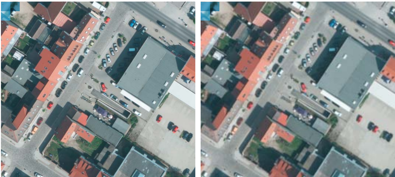
Abb. 1: Auflösungsunterschied DOP20c (links) und DOP40 (rechts)
