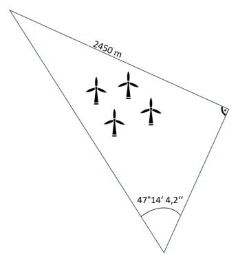
Für eine einzelne Windkraftanlage wird eine Fläche von etwa 6,7 ha benötigt. Berechnen Sie die Anzahl der mathematisch möglichen Windkraftanlagen auf der skizzierten Fläche. Rechnen Sie zu Beginn den Winkel 47°14'4,2" in die Einheit gon um.
