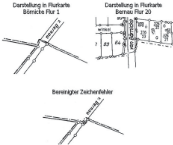
Abb. 5: Unterschiedliche Darstellungen gleicher Grenzverläufe in zwei Flurkarten
