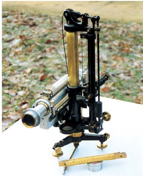
Abb. 3: Das von Prof. Vogler entwickelte Schiebekathetometer
