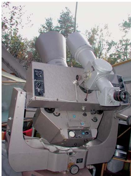
**Abb. 1: Satellitenkamera AFU-75**
