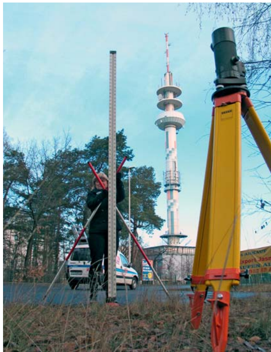
Bild 4: Klassisches Feinnivellement am Funkturn Cottbus
