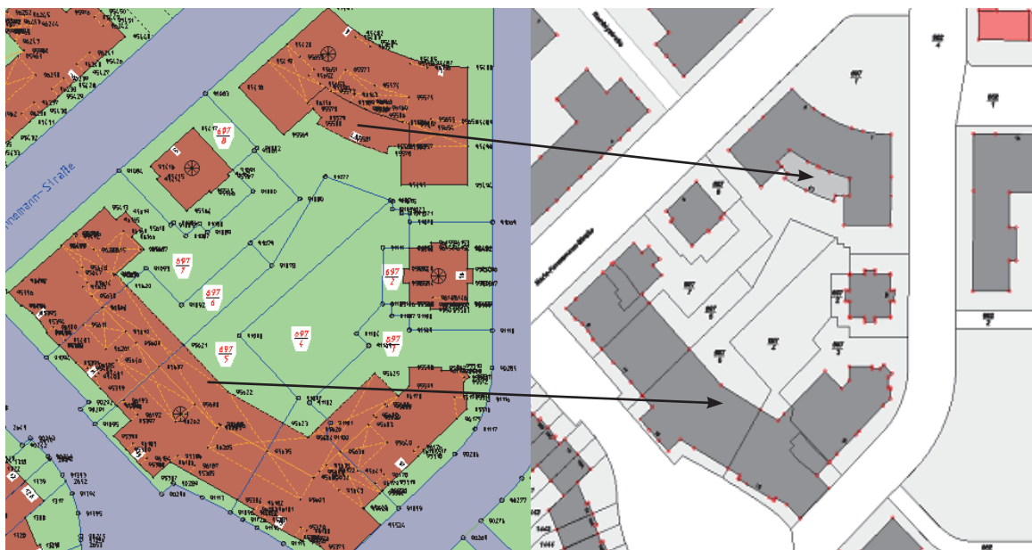
Abb. 10: Beispiel zur entwickelten Erfassungsmethodik für die Ausgestaltungsgeometrien als markantes Merkmal der Gebäudearchitektur für die ALKIS-Migration
