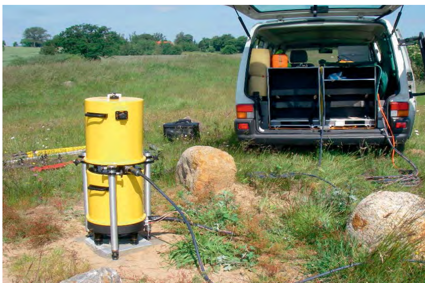
Abb. 6: Messung mit dem Absolutgravimeter A10
