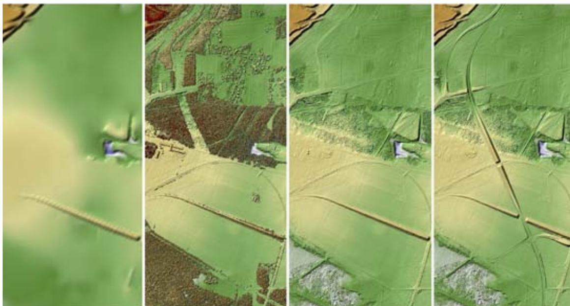
Abb. 6: DGM-Aktualisierung (DGM25-alt, DOM-Laser, DGM-Laser, DGM-aktualisiert)
