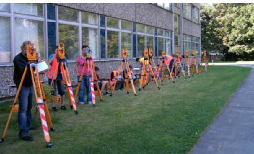
Abb. 5: Auszubildende im Lehrgang „Winkelmessung und trigonometrische Höhenbestimmung“ bei der Richtungsmessung auf dem Gelände der ZAF
