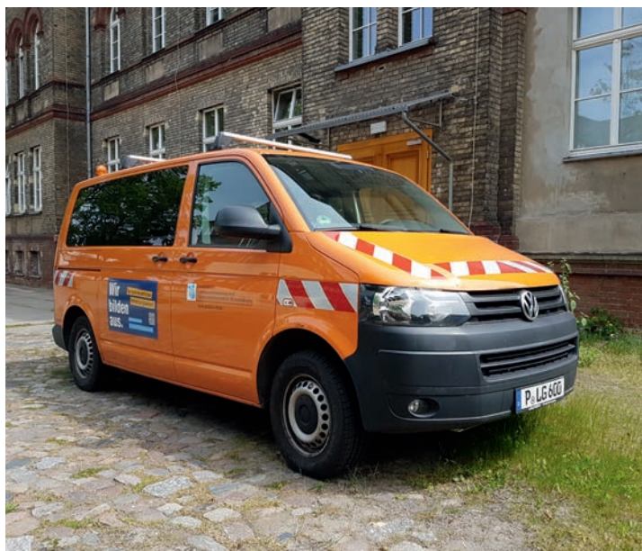
Abb. 2: Kennzeichnung von Arbeits- und Sicherungsfahrzeugen
