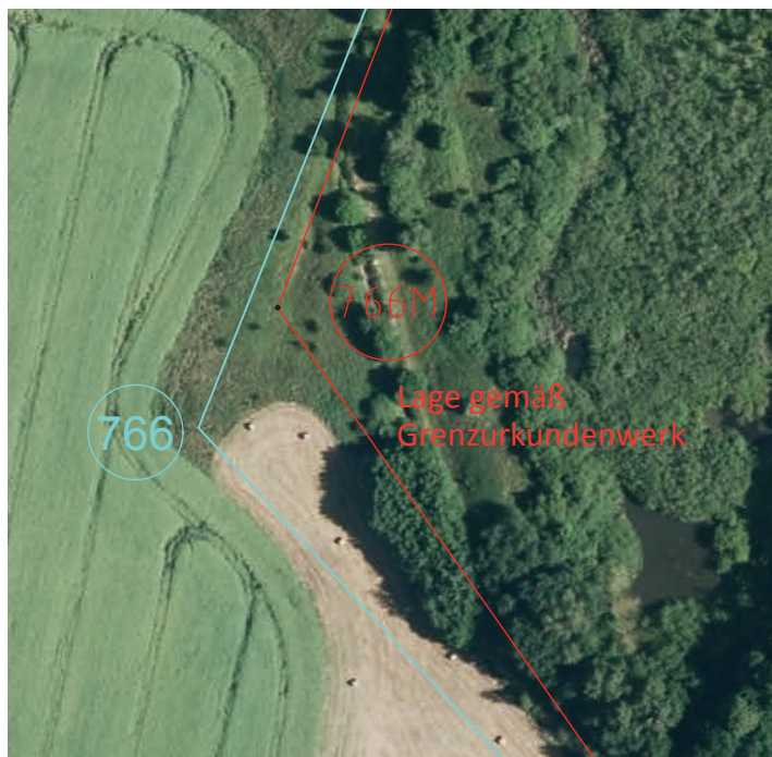
Abb. 4: Lage des Grenzsteins 766 gemäß Grenzurkundenwerk (rot) und vorgefunden (blau)
