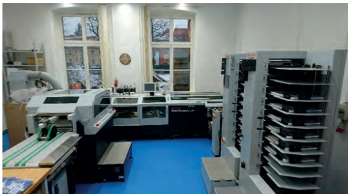
Abb. 6: Neue Produktionsstrecke zur Erstellung von Broschüren
