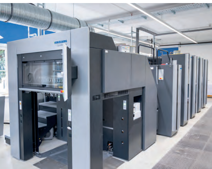
Abb. 4: Bogenoffsetdruckmaschine HEIDELBERG Speedmaster CX-75 4+L
