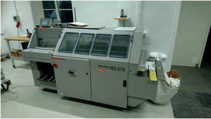
Abb. 9: Klebebinder (1 mm bis 5 mm, bis DIN A3 Format, Auflagen bis ca. 1 000 Stück)
