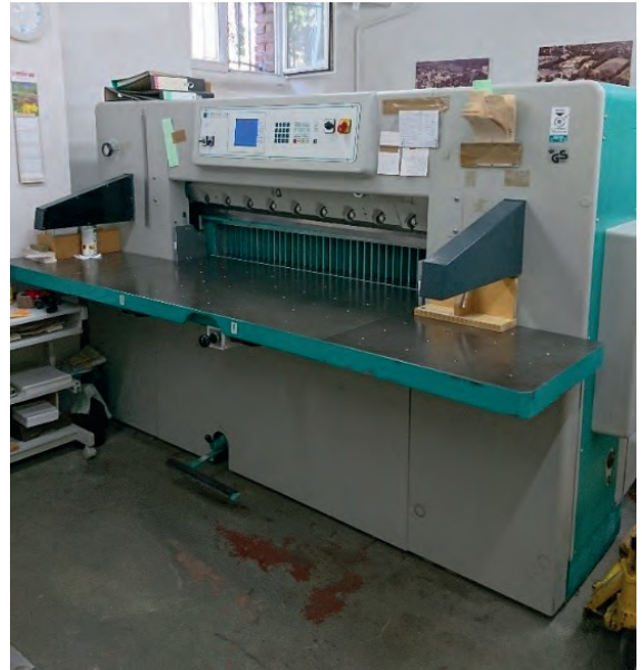
Abb. 10: Schneidemaschine (Buchblöcke bis ca. 8 cm Höhe, Schnittbreite 132 cm)
