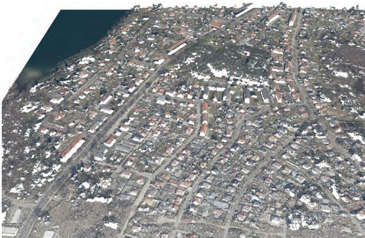
Abb. 4: Die geeignete Darstellung der bDOM-Punktwolke verdeutlicht dessen offene Geometrie bei seitlicher Betrachtung
