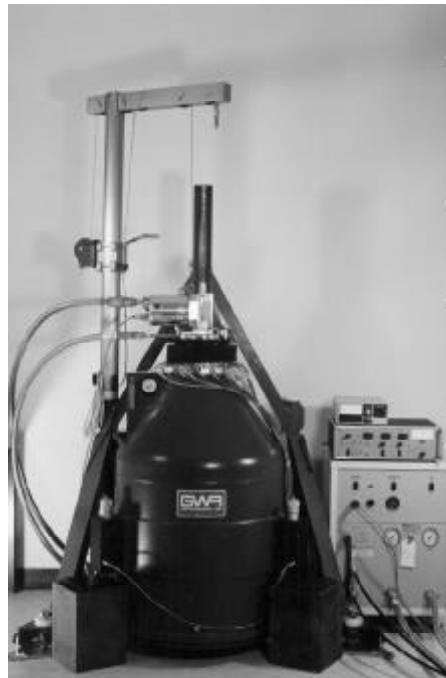
Abb. 4 Das „dual-sphere“ supraleitende Gravimeter
