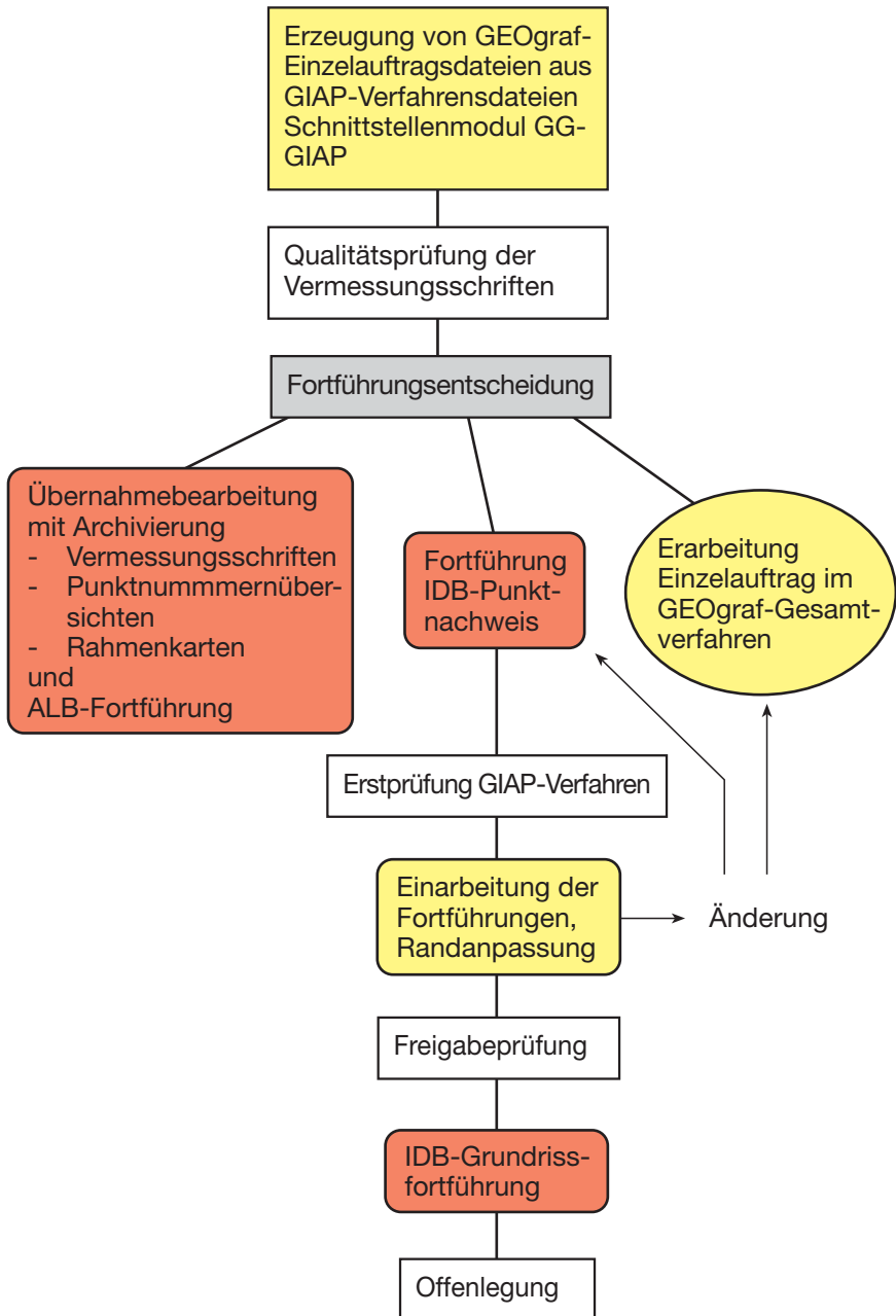
Abb. 3: Verfahrensablauf zur ALK-Einrichtung im KVA Potsdam
