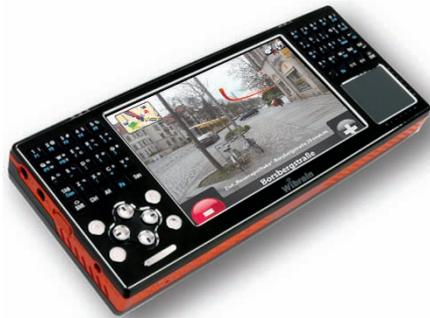
Abb. 11: Navigations-Prototyp auf einen UMPC
