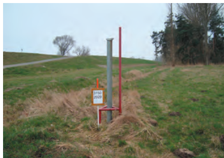
Abb. 2: Typische Formen von Grundwassermessstellen
