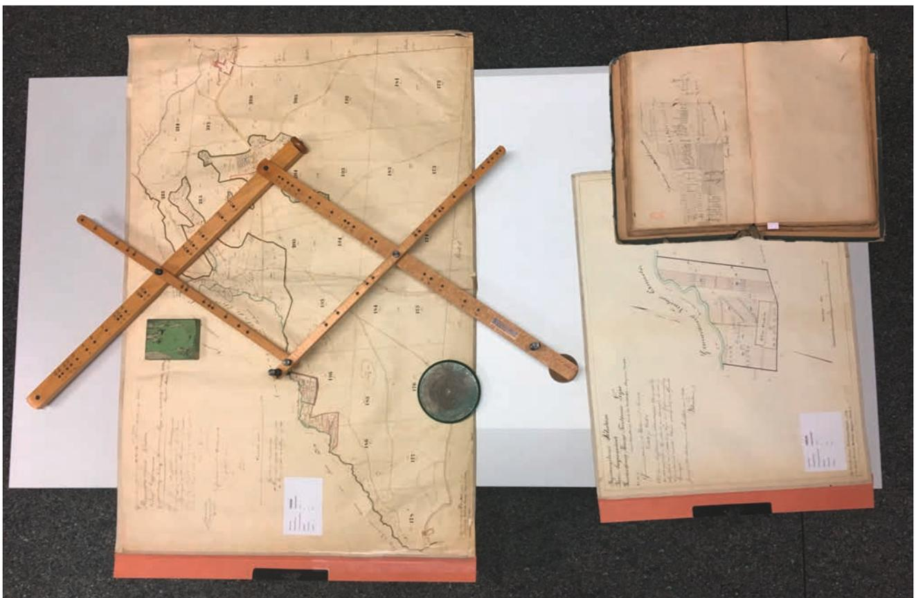
Abb. 7: Demonstrationsaufbau eines Pantographen – hier im Verhältnis 1:2
