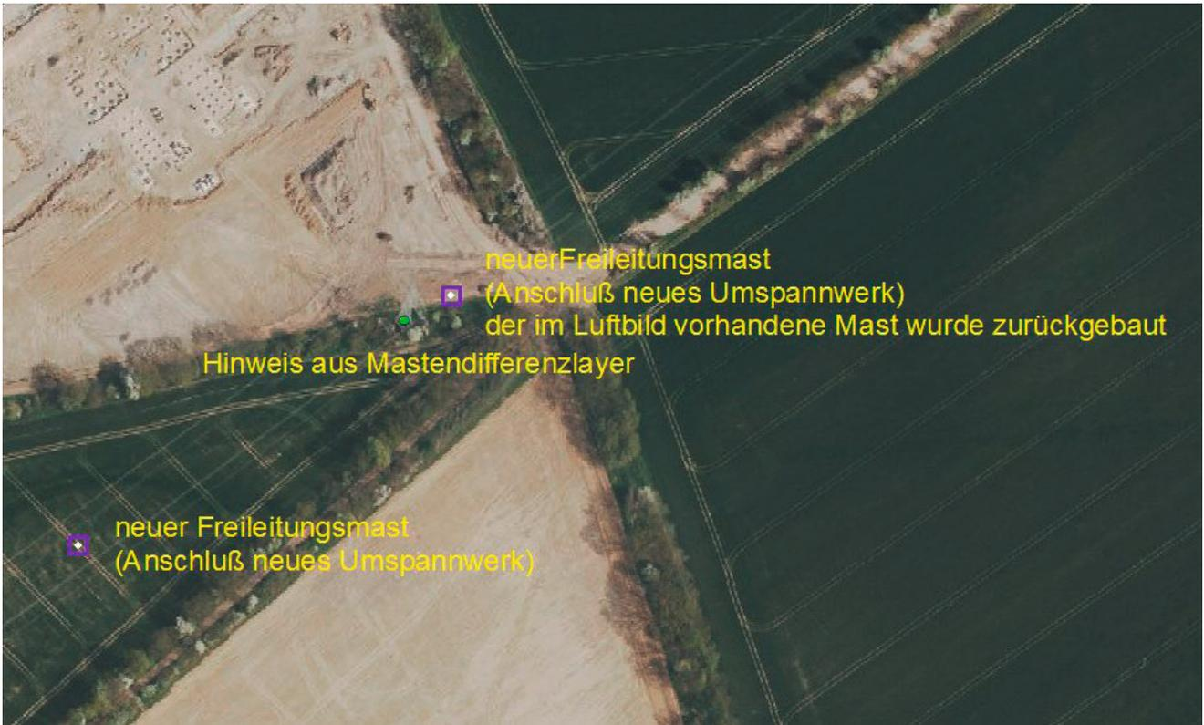
Abb. 3: Hinweise zu vom Gebietstopographen zu kontrollierenden Freileitungsmasten
