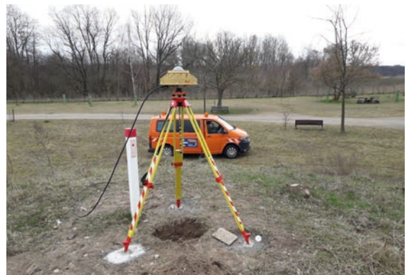
Abb. 4: GNSS-Messung am Grundnetzpunkt Beeskow
