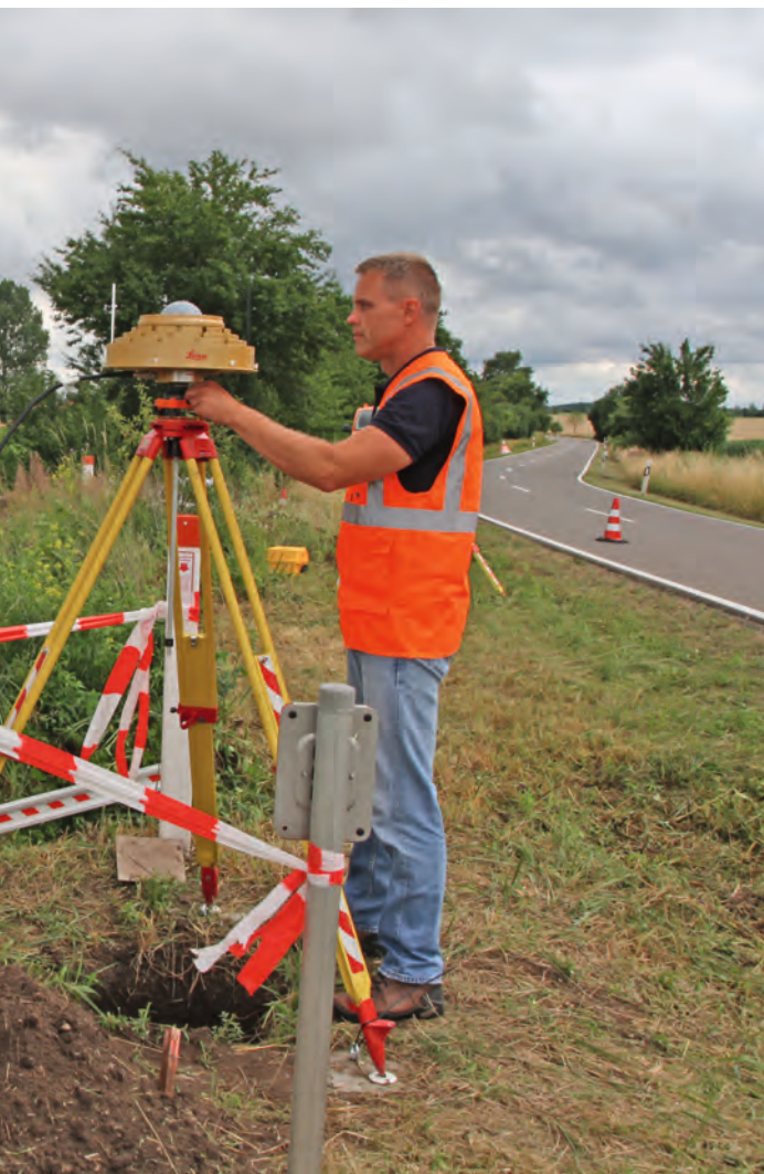
Abb. 3: Vorbereitung der 24h-Messung eines GGP bei Beelitz
