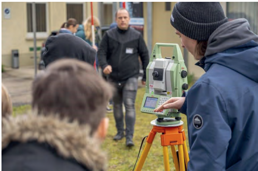
Abb. 1: Messen mit dem Tachymeter
