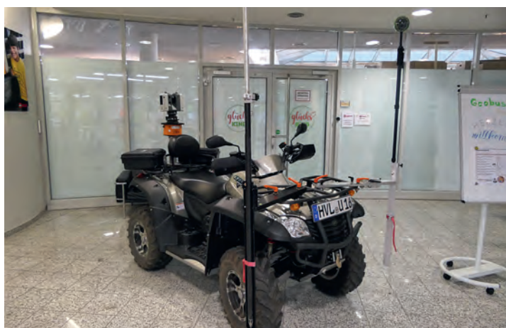
Abb. 5: Multisensorsystem MoveQuad in der Ausbildung
