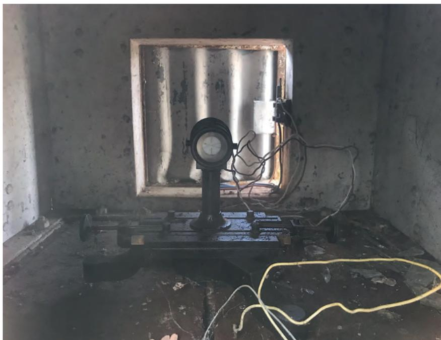
Abb. 9: Mire in einem der drei Wellblech-Mirenhäuser auf dem Telegrafenberg [9]. Vorderansicht der elektrisch beleuchteten Mire mit einem Fadenkreuz auf einem justierbaren Unterbau, wohl nach 1900. Diese „Nahmire“-Einrichtung war nur für kürzere Messdistanzen ausgelegt und stellt ein weiterentwickeltes Vergleichsobjekt zu den ursprünglich in den Fernmiren installierten Miren-Einrichtungen dar, Bildrechte: Alina Pilz, 2023.
