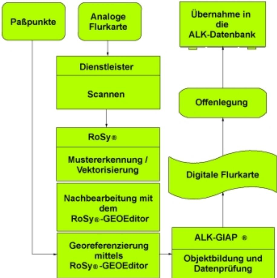
**Abb. 2: Schematischer Verfahrensablauf**
