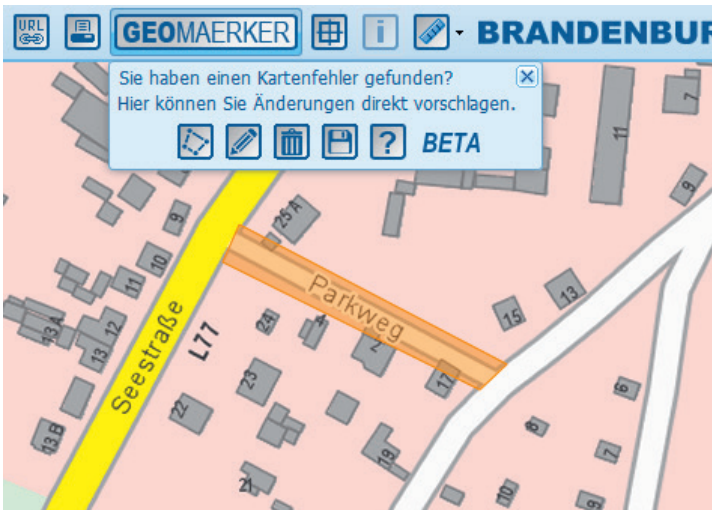
Abb. 3: Das zu korrigierende Objekt wird mit einem Umringspolygon markiert
